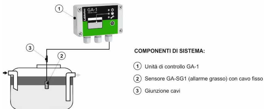
Figura 1. Supervisione del separatore di grasso con dispositivo di allarme GA-1
