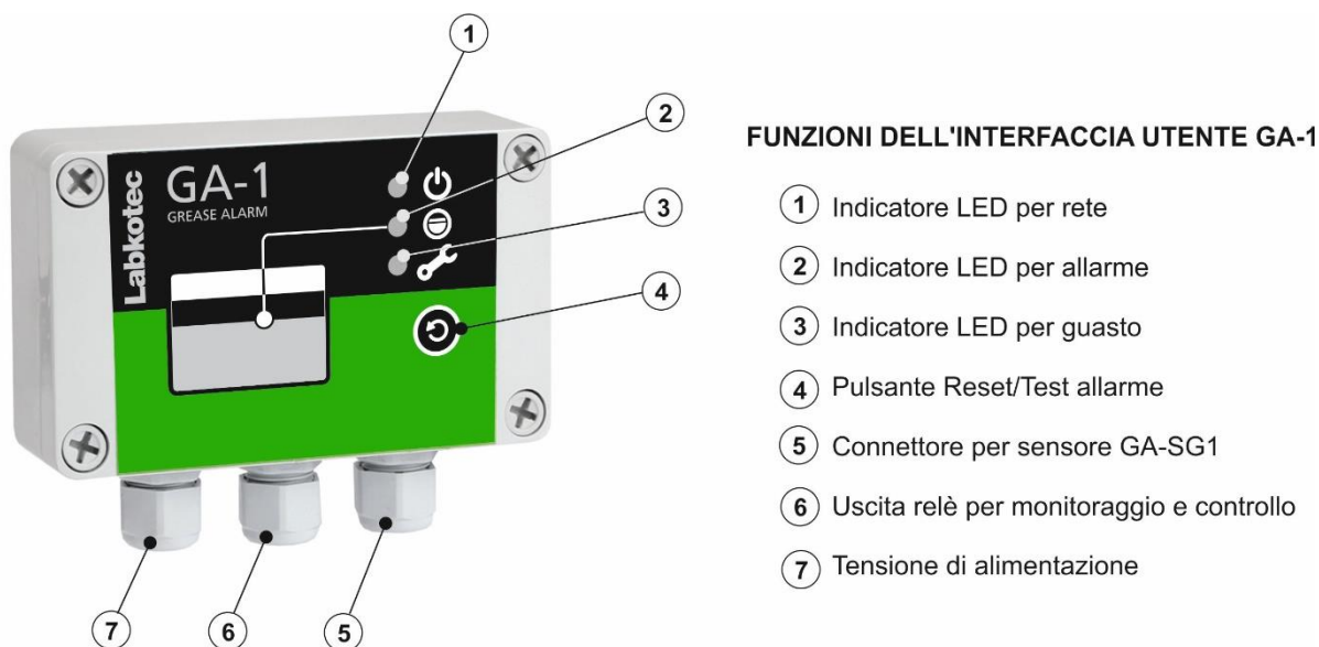
Figura 2. Unità di controllo GA-1 - Funzioni
